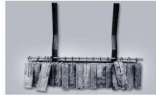
Test pembebanan 300 kg pada dinding menggunakan LB 60 mm.
